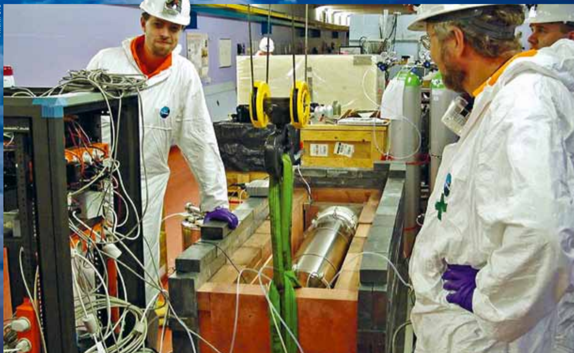
Kammeret som til en vis grad efterligner jordens atmosfære, pakkes godt ind i bly og kobber, for at eliminere baggrundsstrålingen fra minen. Den kosmiske stråling er så godt som væk 1100 meter under jorden.
